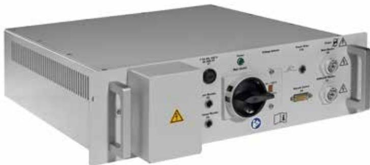
Dieses Gerät stellt eine zentrale Stromversorgung für ein sog. Large Monitor Subsystem dar. Es befindet sich in einem 19"-Schrank und versorgt dessen Komponenten, z.B. A/D-Konverter, Splitter, Videoübertragungsmodule, etc. mit Strom. Zusätzlich können bis zu zwei 8 Mega-Pixel Großbildmonitore betrieben werden.
